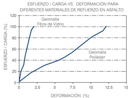
Para una carga de rotura, un refuerzo con Geomalla de Fibra de Vidrio admitirá deformaciones menores al 3%, mientras que la Geomalla de poliéster (PET) admite deformaciones entre el 10 y 15%. De acuerdo con lo anterior, las Geomallas de Fibra de Vidrio presentan una mejor eficiencia cuando son usadas como refuerzo de carpetas asfálticas frente a otras alternativas de refuerzo.
